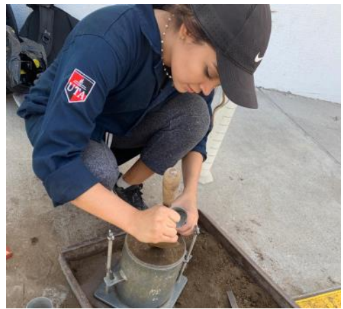
Ensayo Proctor modificado
