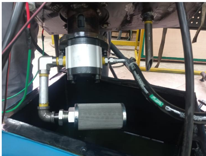
Figura 59. Unidad hidráulica preensamblada con motor, bomba, filtro de succión y matrimonio.
