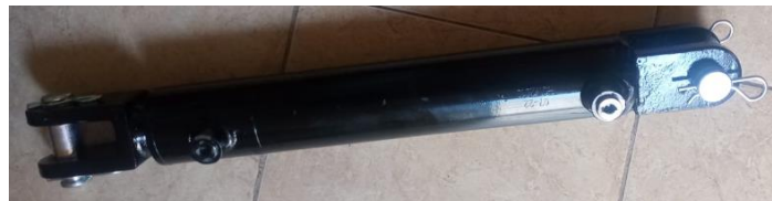
Figura 51. Cilindro hidráulico HN hydraulic HCW 2.5x8”.
