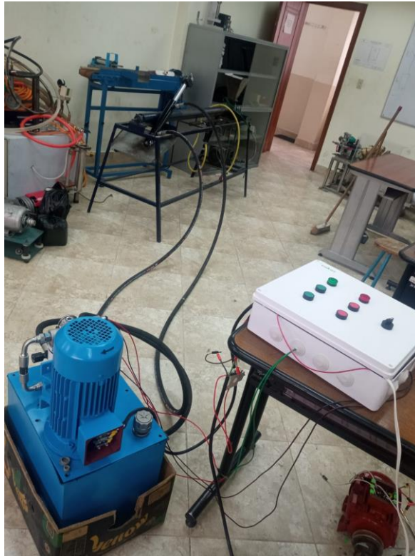
Figura 65. Sistema hidráulico para una máquina de pruebas para conexiones metálicas viga-columna (ensamble final).
