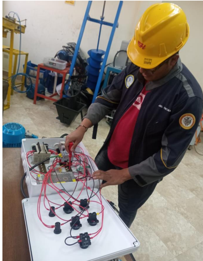
Figura 61. Sistema de control preensablada.
