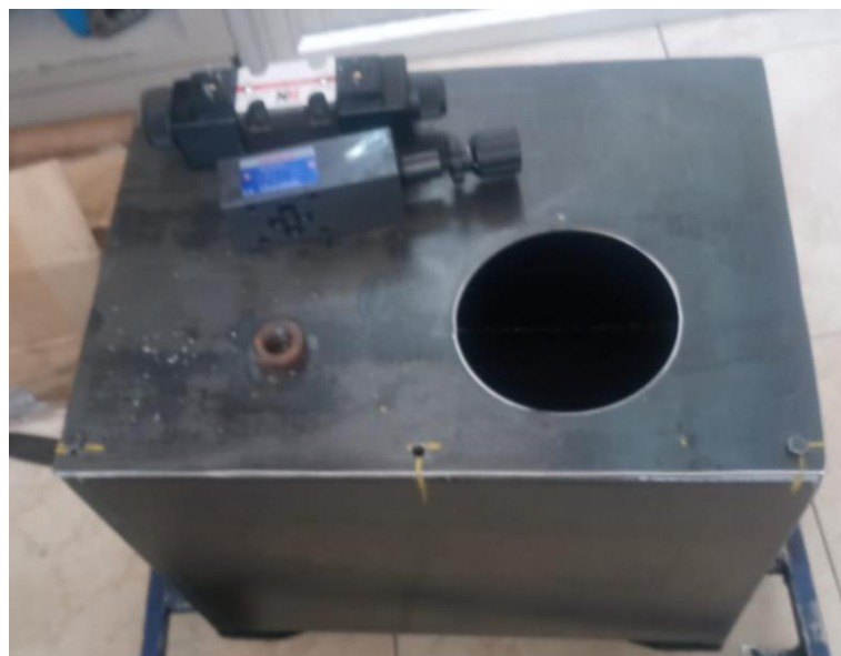
Figura 58. Diseño y construcción del depósito de la unidad hidráulica.
