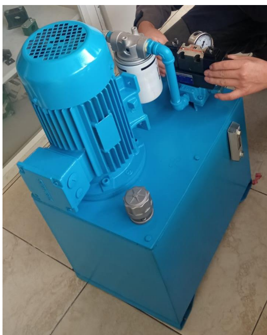
Figura 60. Unidad hidráulica preensamblada con manómetro, visor de nivel, válvula de alivio, electroválvula, tapa filtro, mangueras hidráulicas y el cilindro.
