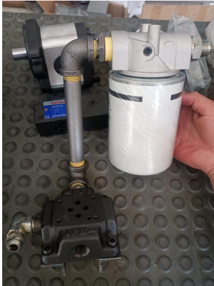
Figura 57. Unidad hidráulica preensamblada con el filtro de retorno y sub placa cetop 3.
