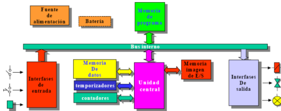
Figura 21. Diagrama de bloques de la arquitectura de un PLC [24].
