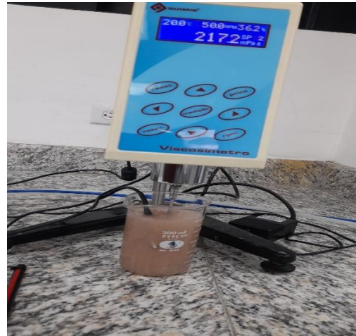
Fotografías F12 y F13: determinación de la viscosidad del néctar de mucílago de cacao (izquierda Guayas – derecha Sucumbíos).
