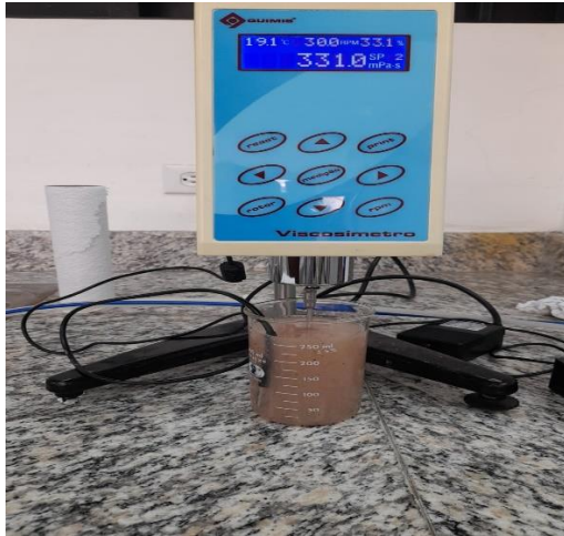
Fotografías F12 y F13: determinación de la viscosidad del néctar de mucílago de cacao (izquierda Guayas – derecha Sucumbíos).
