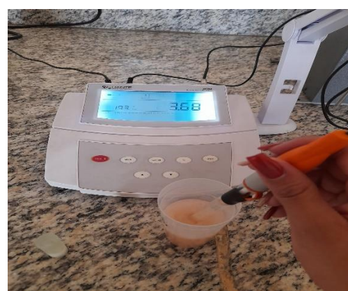
Fotografías F10 y F11: Determinación del pH de las muestras provenientes de Sucumbíos.
