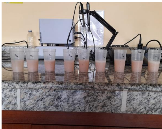
Fotografías F8 y F9: Determinación del pH de las muestras provenientes de Guayas.
