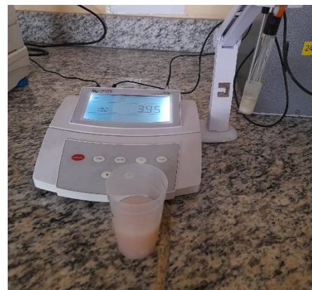
Fotografías F8 y F9: Determinación del pH de las muestras provenientes de Guayas.
