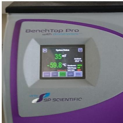
**Figura 13.** Verificación de parámetro del equipo liofilizador BenchTop Pro.
