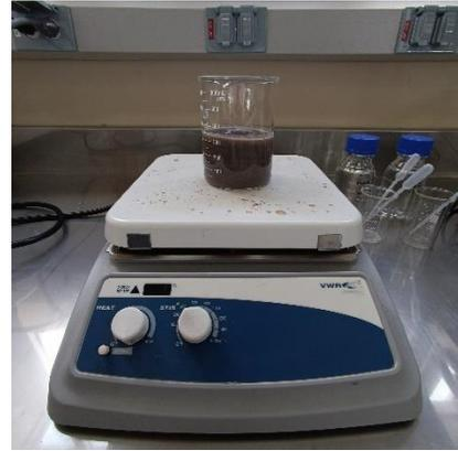
**Figura 24.** Homogeneizado de muestras en agua destilada con un agitador.
