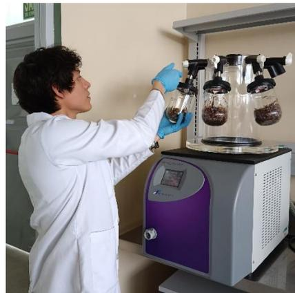
**Figura 14.** Ingreso de muestras al equipo liofilizador.
