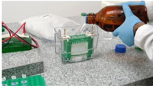
**Figura 51.** Colocación de buffer running en cámara de electroforesis.
