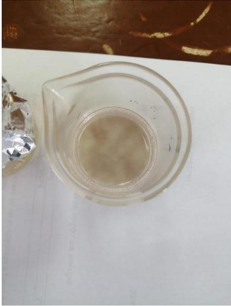
**Figura 9.** Prueba de nitrato de plata
