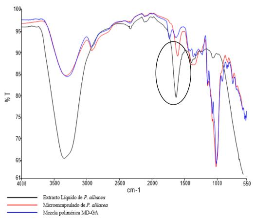
Se observa tres ensayos superpuestos correspondientes a la mezcla polimérica como agente encapsulante, al extracto líquido y microencapsulado de *P. alliacea*.
