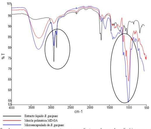
Se observa tres ensayos superpuestos correspondientes a la mezcla polimérica como agente encapsulante, al extracto líquido y microencapsulado de *B. gasipaes*.
