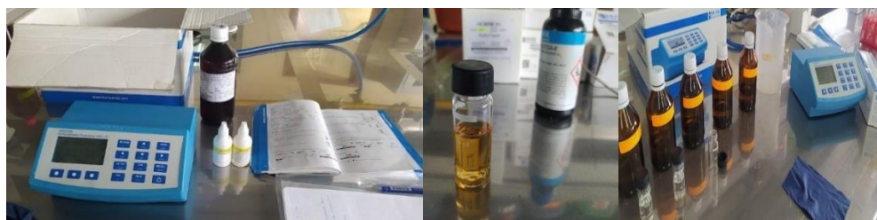
Figura 11. Uso del fotómetro HANNA para la medición de parámetros fisicoquímicos en muestras de aguas y sedimentos
