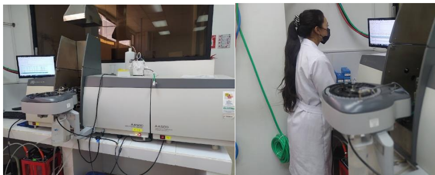
Figura 12. Uso del GFASS para la medición metales en muestras de aguas y sedimentos
