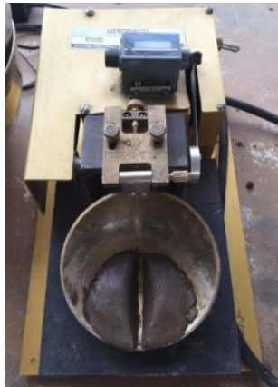
Ilustración 25 Ensayo Limite Liquido - Angamarca
