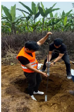
Ilustración 20: Ensayo DCP Angamarca
