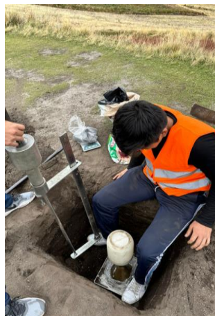
Ilustración 21 : Ensayo Cono y Arena - Angamarca
