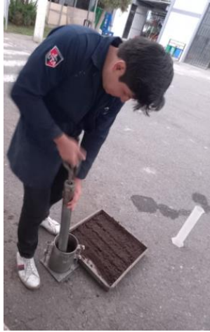
Ilustración 27 : Ensayo Proctor - Angamarca
