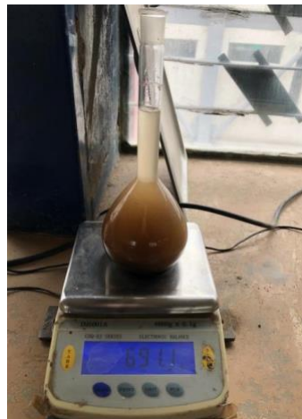
Ilustración 24 Gravedad específica - Angamarca
