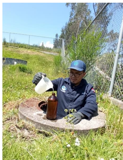
Figura 14. Toma de muestras de agua residual de salida de la PTAR Callate. Fuente: Autor
