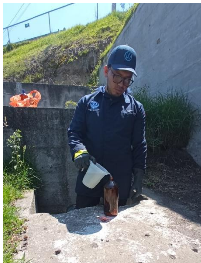
Figura 13. Toma de muestras de agua residual de entrada de la PTAR Callate. Fuente: Autor
