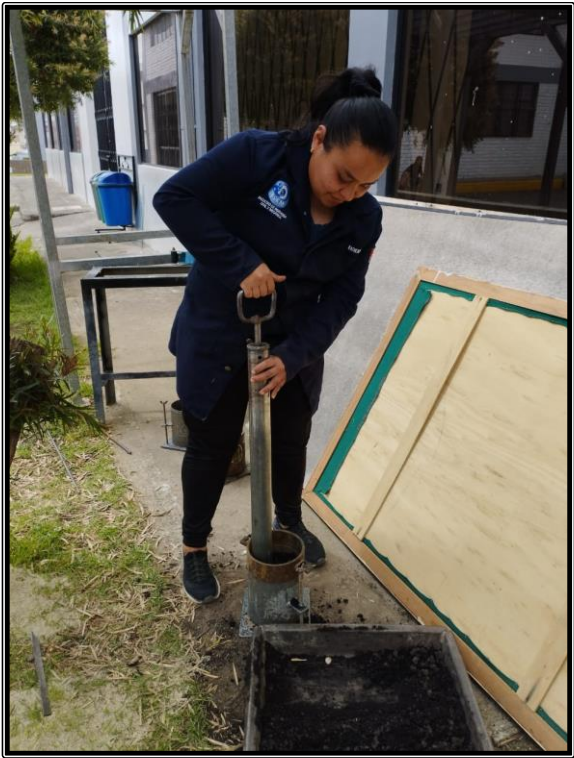
Ilustración 54: Ensayo Proctor Modificado
