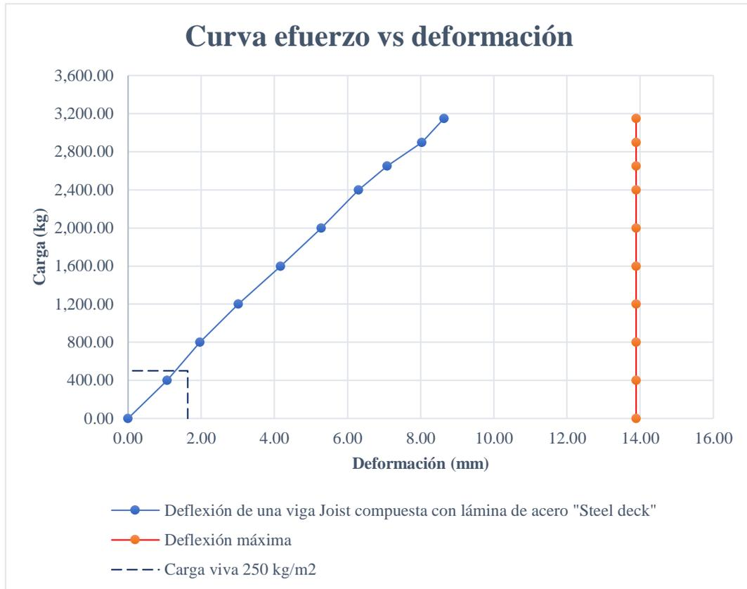
**Gráfico 43.** Carga deformación de una viga Joist compuesta con lámina de acero “Steel deck”
