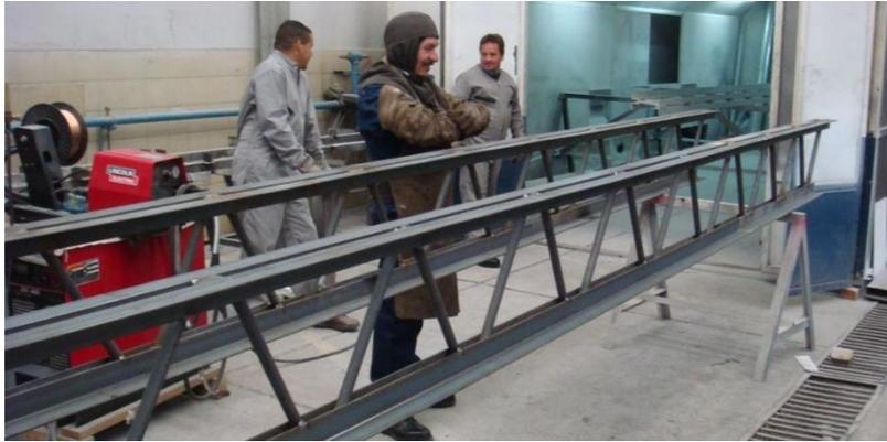
**Gráfico 10.** Construcción de viga Joist con diagonales de hierro redondo
