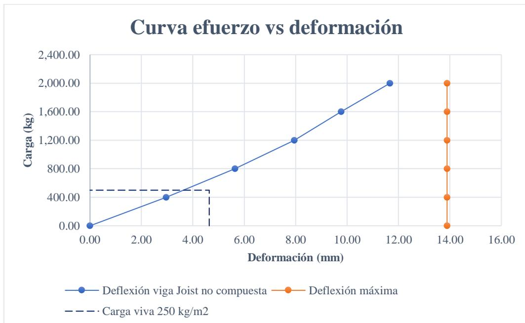
*Gráfico 40. Carga deformación de una viga Joist no compuesta*
