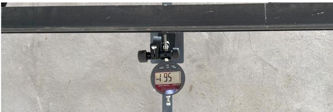
**Gráfico 36.** Deformímetro "Clockwise Tools DICR-0105"
