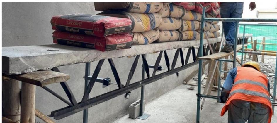
*Gráfico 38. Muestra de experimento de la viga Joist compuesta con losa maciza*
