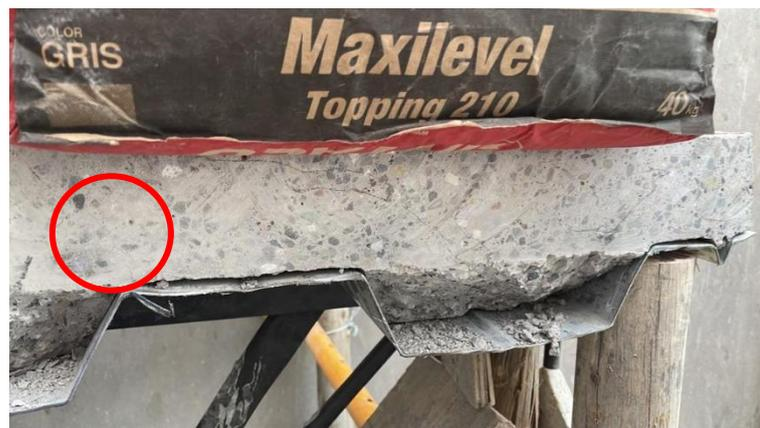
**Gráfico 44.** Falla del hormigón el sistema de piso con lámina metálica
