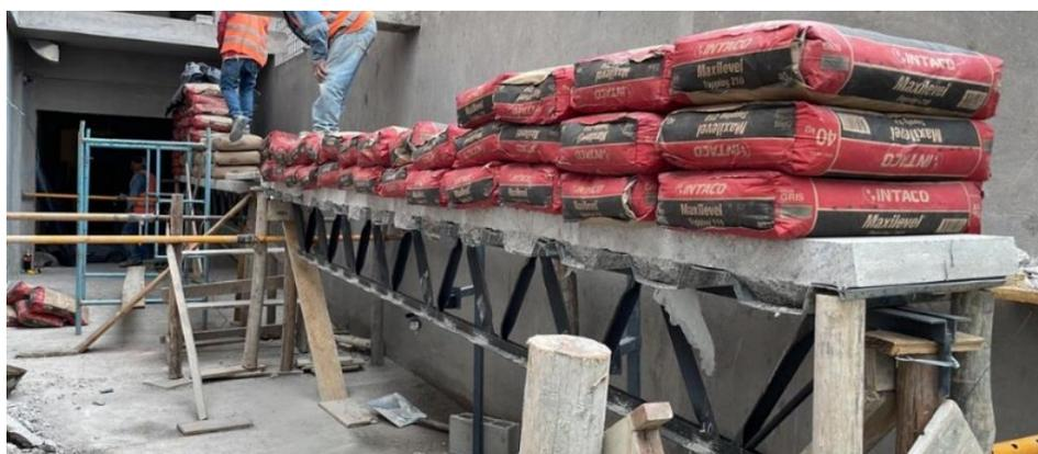
*Gráfico 39. Muestra de experimento de la viga Joist compuesta con lámina de acero "Steel deck"*
