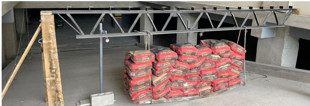
*Gráfico 37. Muestra de experimento de la viga Joist no compuesta*
