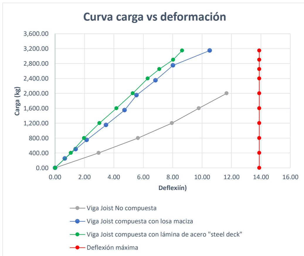
**Gráfico 45.** Análisis comparativo de vigas Joist no compuestas vs vigas Joist compuestas
