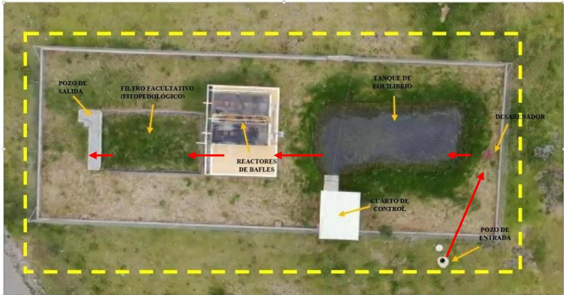
Figura 25. Estructura en planta de PTAR de la parroquia Mulaló
