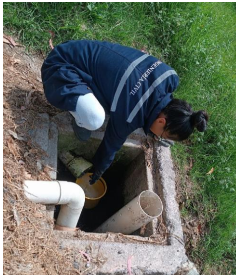
Figura 20: Medición del caudal de salida de la PTAR Tres Esquinas.
