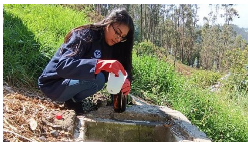
Figura 3: Recolección de muestras de agua residual de la PTAR Tres Esquinas.
