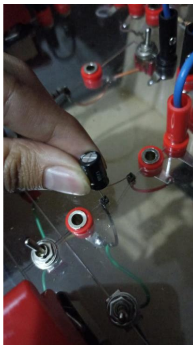
Figura 4. Capacitor colocado en el circuito.
