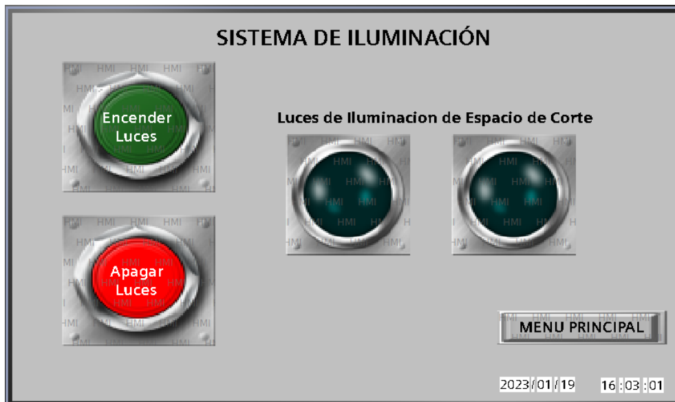
Anexo 9.13. Pantalla del Sistema de Iluminación.
