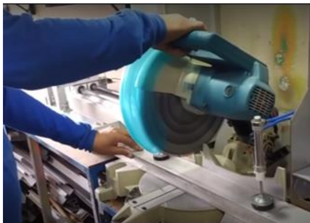
Anexo 12.17. Funcionamiento automático de los cilindros neumáticos durante el corte.
