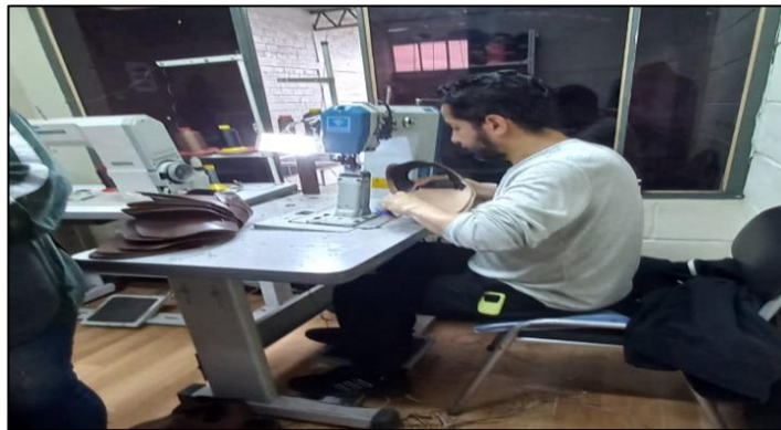
Figura 11. Proceso de aparado
