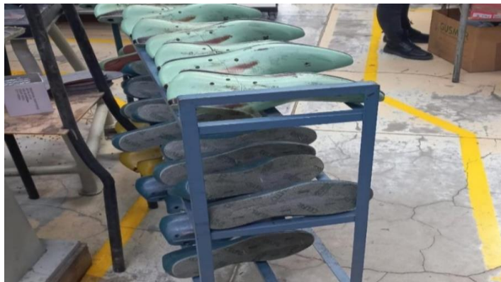
Figura 13. Previo al montaje, preparación de hormas.
