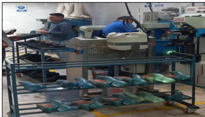
Figura 15. Proceso de montaje (armado de talones)
