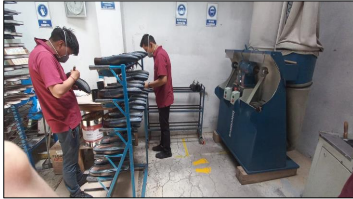
Figura 16. Proceso de cardado y rayado
