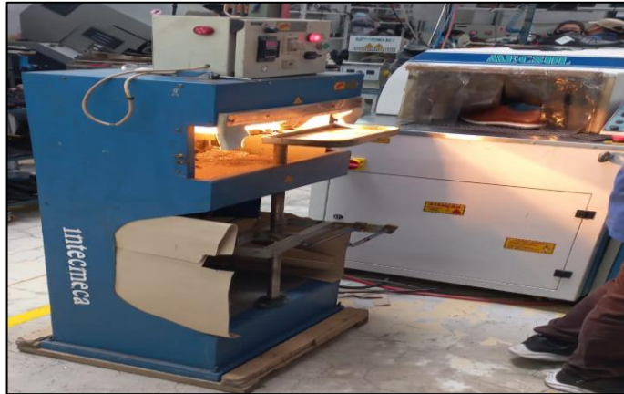
Figura 18. Proceso pegado de suelas
