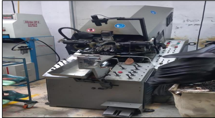
Figura 14. Proceso de montaje (armado de puntas)
