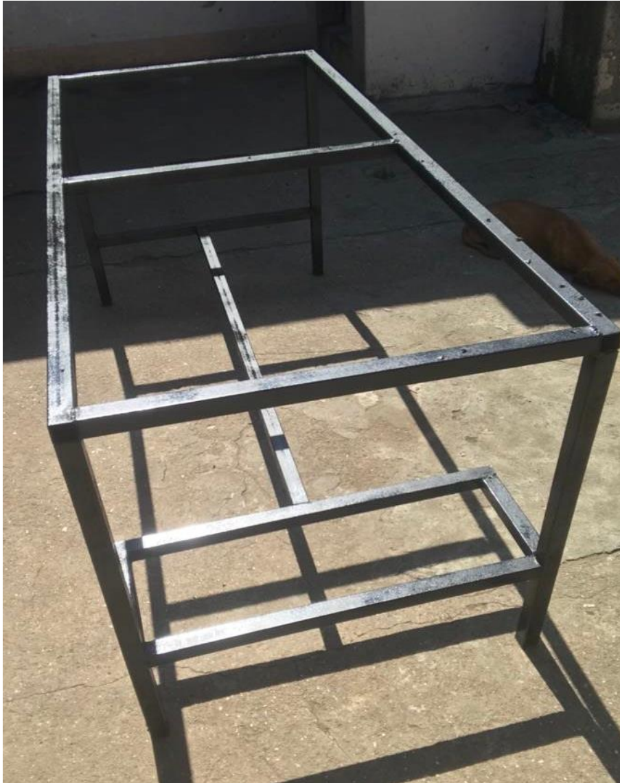
Figura 78. Estructura final para el sistema fotovoltaico
