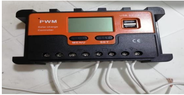
Figura 26. Controlador de carga
