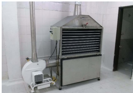
Figura 4. Deshidratador de charolas con aire caliente [14].
