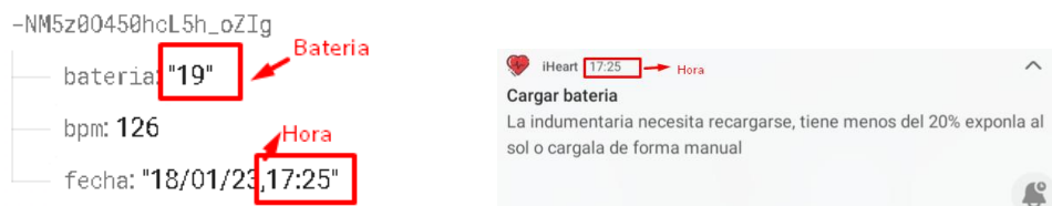
a) Hora y nivel de batería en base de datos b) Notificación de alerta en dispositivo móvil
