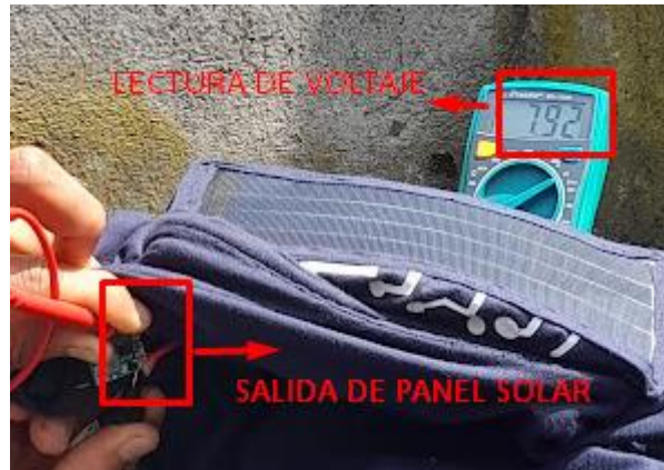
Figura 28. Medición de voltaje a la salida del reductor de voltaje en día soleado
