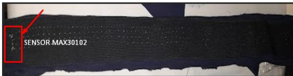
a) Parte trasera de elástico con sensor MAX30102
