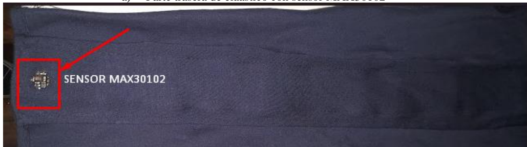
b) Parte delantera de elástico con sensor MAX30102
