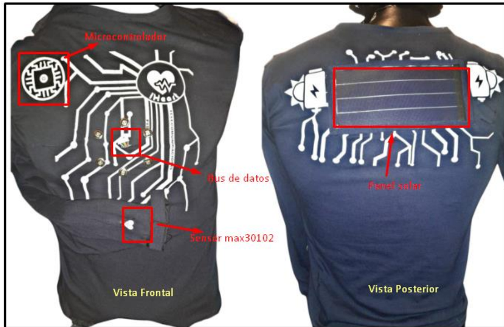
Figura 27. implementación final de indumentaria electrónica
