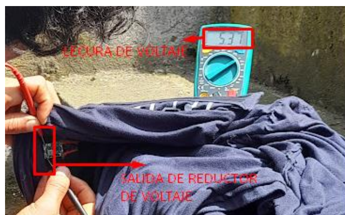
Figura 29. Medición de voltaje a la salida del panel en día soleado
