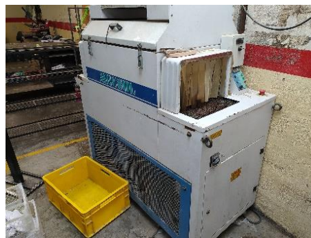
Figura 30.- Túnel de enfriado para calzado
