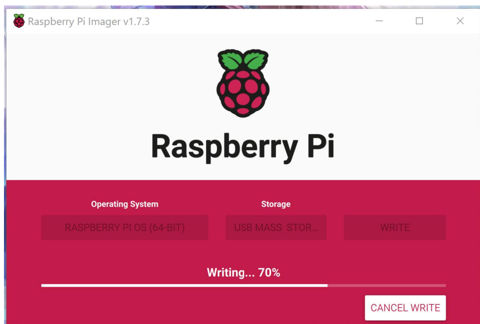
Figura 3.18 Instalación del sistema operativo en la Micro SD.
