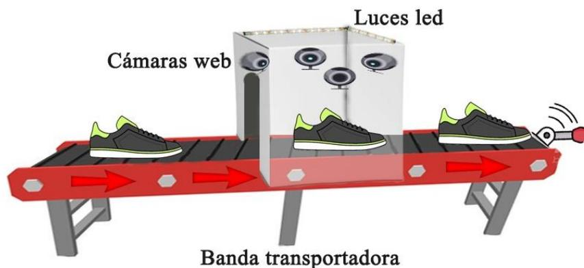
Figura 41. Diseño de prototipo de sistema de clasificación industrial
