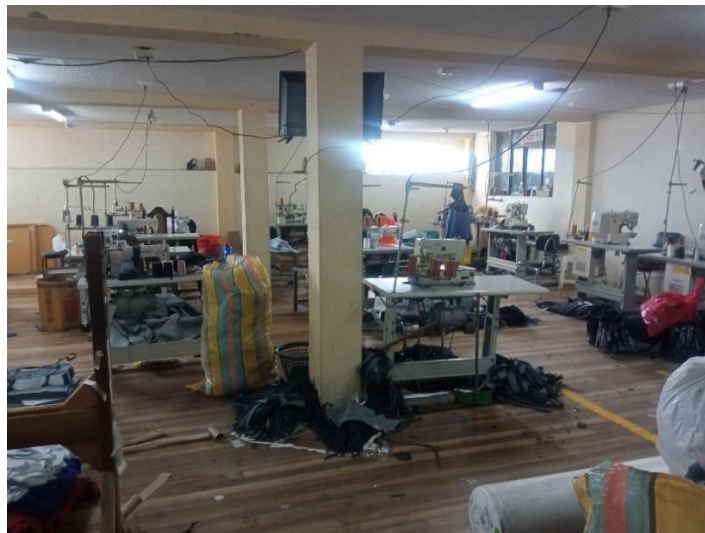
Figura 51. Inexistencia de señalética y delimitación actual
