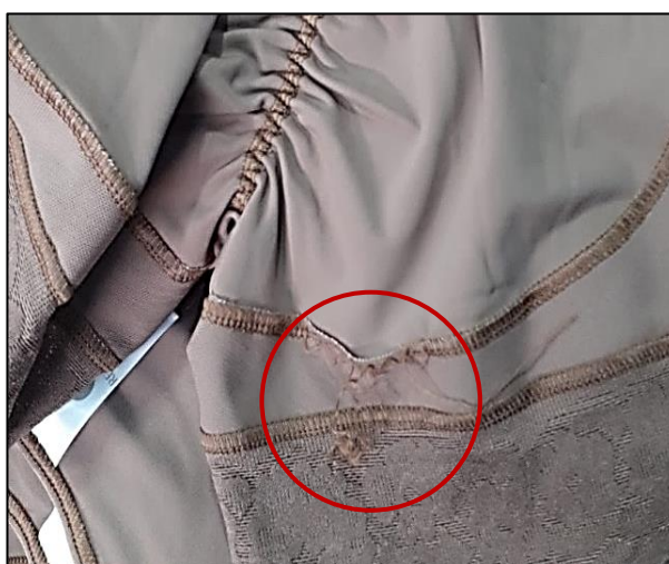
Figura 47. Salto de puntada en la prenda
