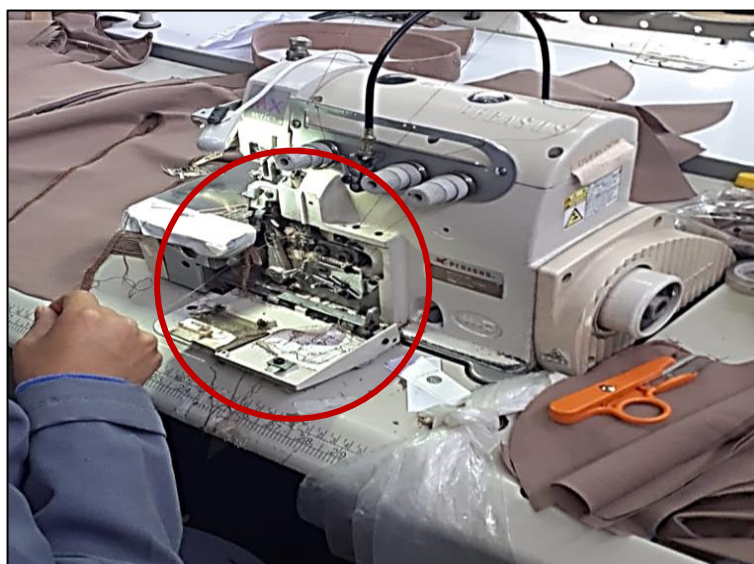
Figura 49. Paro inesperado por daño interno en máquina overlock
