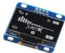
Figura 25. Pantalla oled de 0,96 pulgadas [105]
