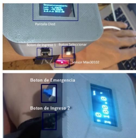
Figura 34. Implementación de los componentes en el prototipo
