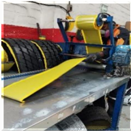
Figura 15. Proceso de corte de banda
