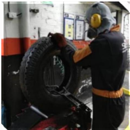
Figura 18. Proceso de inspección final
