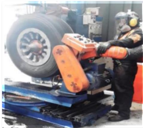
Figura 10. Proceso de raspado de carcasa
