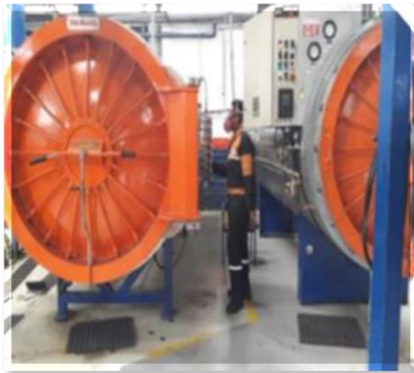
Figura 17. Proceso de vulcanizado
