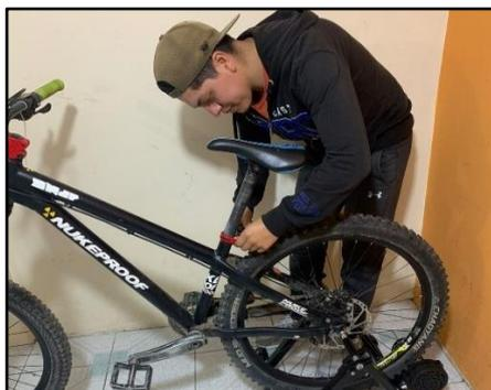
**Figura 72** Ajuste de la altura del sillín en la segunda prueba.
