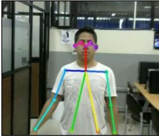
**Figura 80** Esqueleto en 2D del algoritmo Openpose [49]
