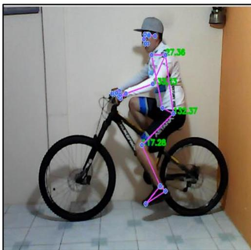
**Figura 77** Ángulos medidos por el sistema electrónico.
