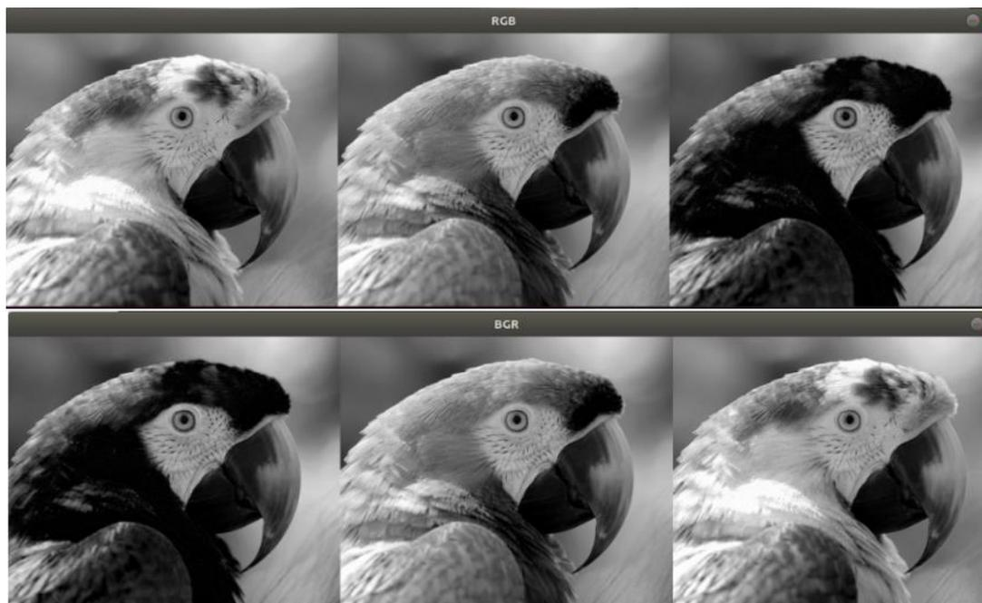
**Figura 29** Canales RGB de la imagen leída y canales BGR después de aplicar la función `cv2.cvtColor [46]`
