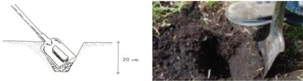
Figura 8: Toma de las submuestras del terreno en corte de V y a una profundidad de 20cm
