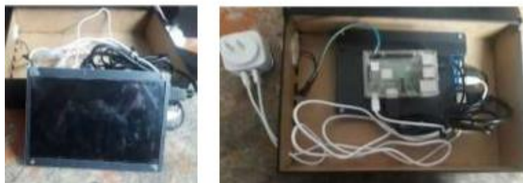
Figura 34: Implementación del LoRa Gateway y la interfaz de usuario
