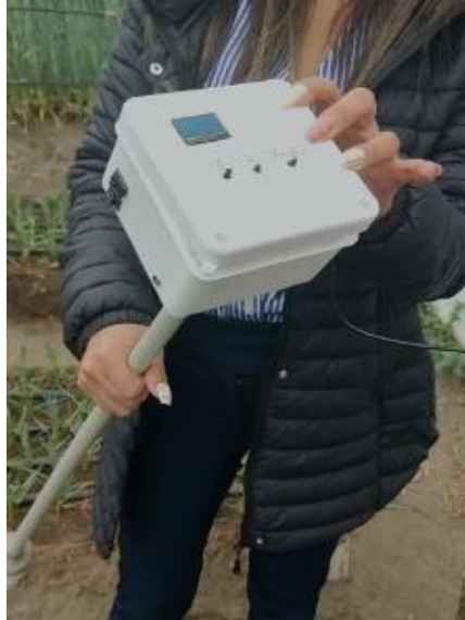
Figura 32: Nodo Lora Prototipo de sensorización para pruebas de nutrientes
