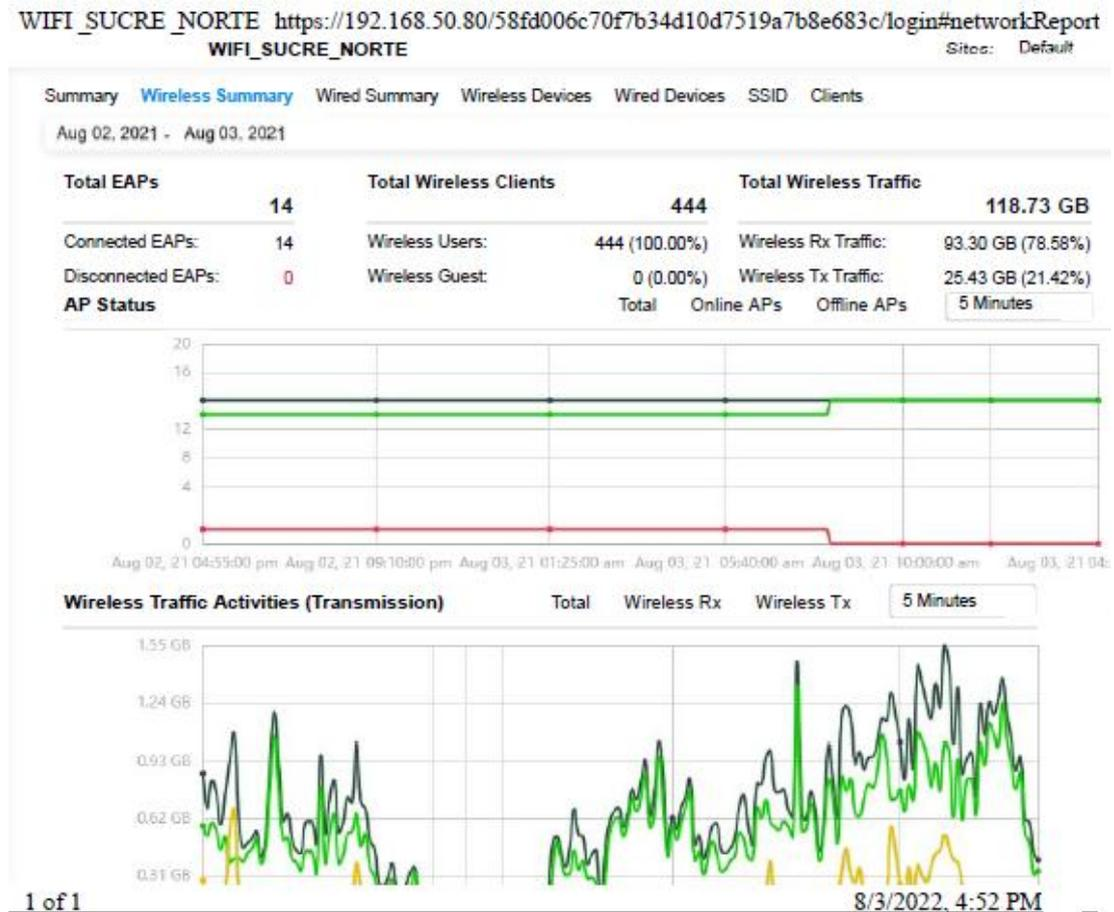
**Nota.** Resumen de datos del tráfico originado en la red inalámbrica, obtenido de software de control OMADA- TP LINK. **Fuente:** Elaboración propia
