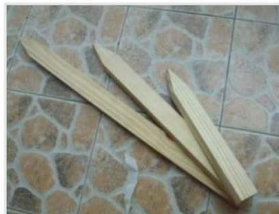
Figura 19: Estacas de Madera
