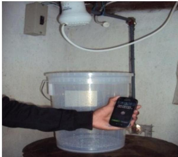
**Figura 3.13:** Medición cantidad de litros de agua por minuto
