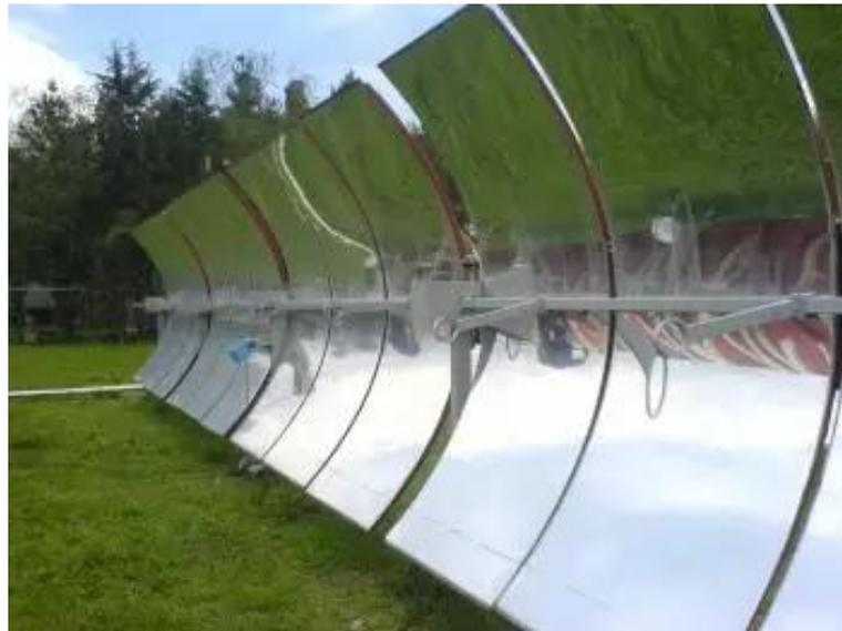
**Figura 3.28:** Estructura colector solar parabólico [37]
