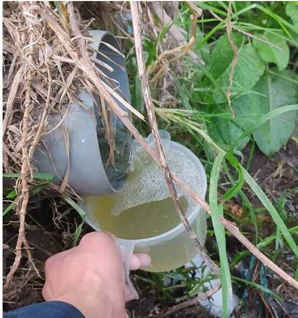
Figura 31. Medición de caudales de salida por método volumétrico. Fuente: Alex Fernández
