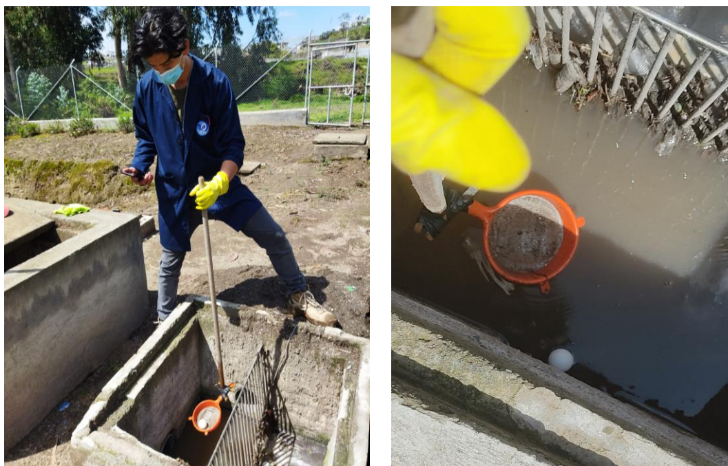
Figura 30. Medición de caudales de entrada por método del flotador.
