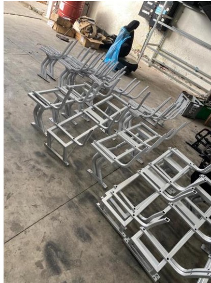
Fig. 15. Estructura del asiento
