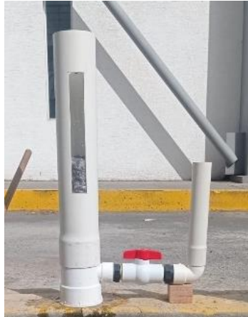
Figura 5 Permeámetro de carga variable
