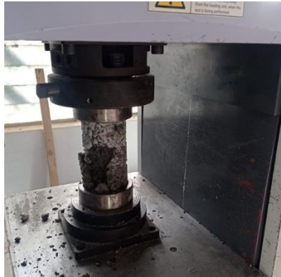
Figura 6 Ensayo a compresión
