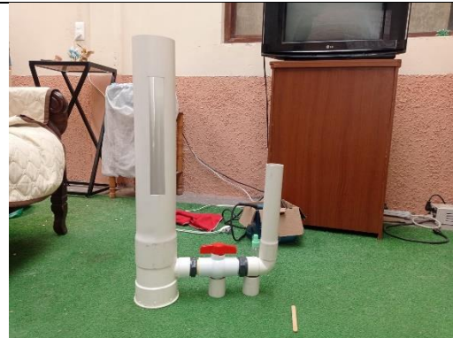
Descripción: Permeámetro de carga variable.
