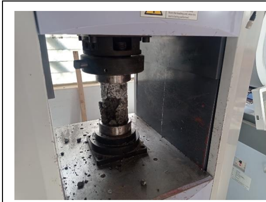
Descripción: Ensayo de compresión.
