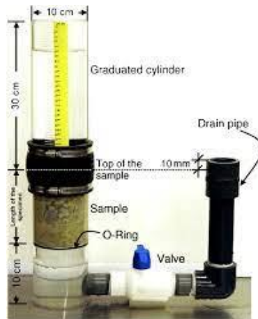
Figura 3 Permeámetro de carga variable de Neithenath
