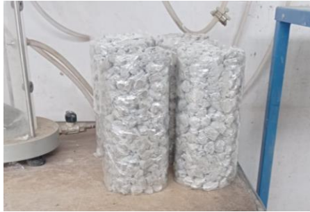
Figura 4 Preparación de cilindros para ensayo de permeabilidad
