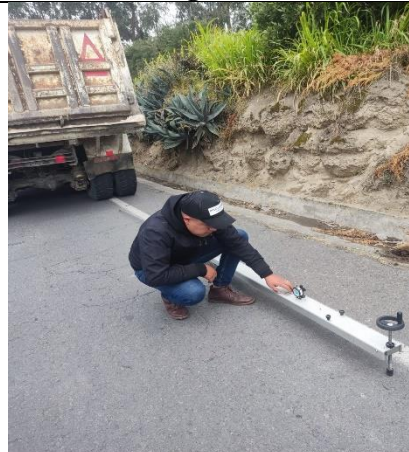
Nivelación de Viga Benkelman
