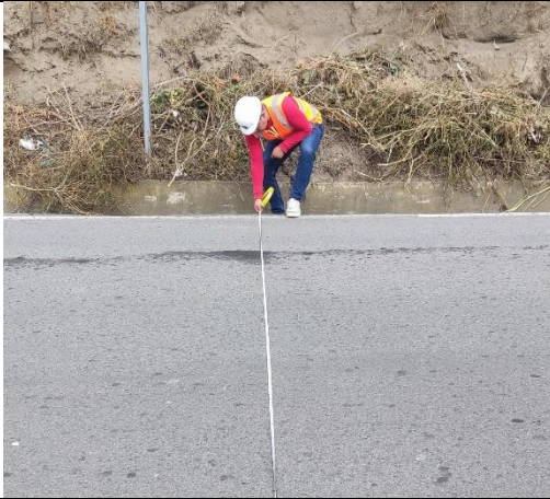
Medición de anchos de vía
