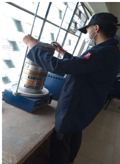
Ilustración 2. Ensayo de Granulometría Diego Pizarro
