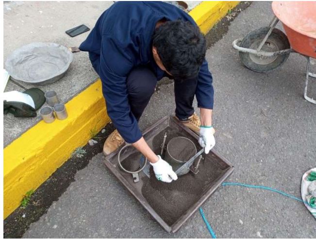
Ilustración 5. Ensayo de Proctor Modificado realizado por Diego Pizarro
