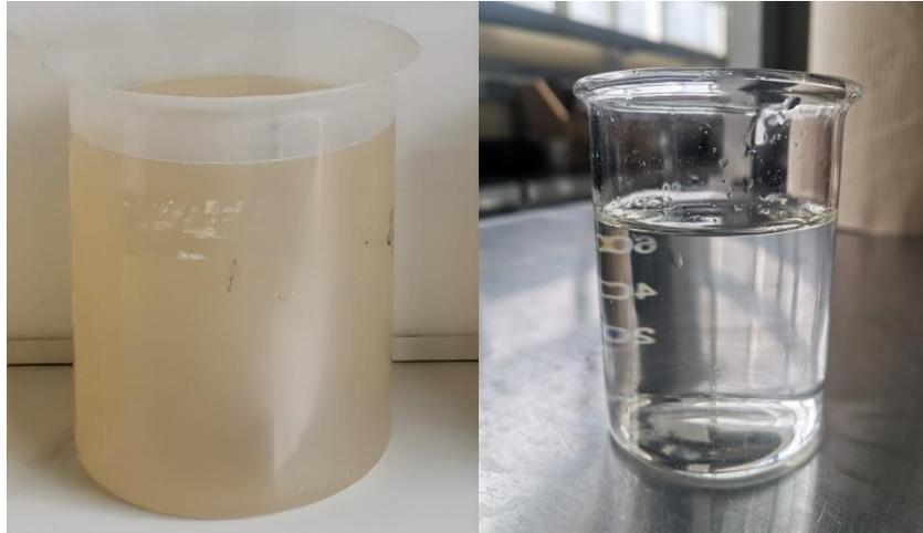
La imagen del antes (izquierda) muestra el efluente con un color marrón oscuro, lo que indica una alta concentración de materia. Sin embargo, la imagen después del tratamiento (derecha) revela un cambio notable, con una disminución significativa del color, mostrando un agua mucho más clara y limpia. Este cambio visual evidencia la eficacia del tratamiento Fenton en la remoción de contaminantes y la mejora de la calidad del agua residual.
