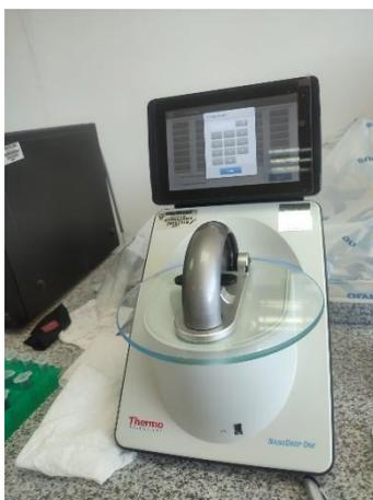
**Imagen 14.** Cuantificación de fenoles, flavonoides y fructosa por espectrofotometría.
