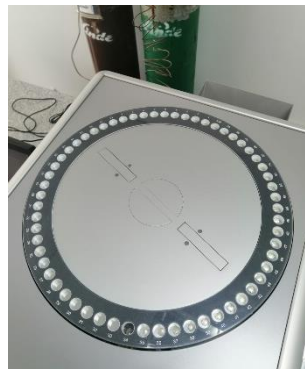
Ingreso de cápsulas en el equipo Dumas.
