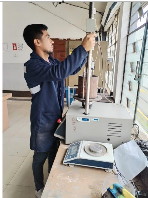
Fotografía 1. Ejecución del ensayo CBR
