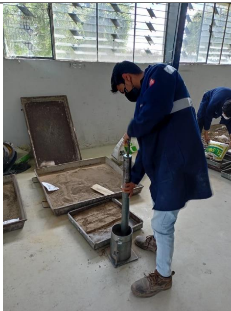
Fotografía 1. Ejecución del ensayo Proctor tipo B
