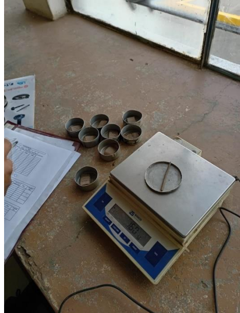
Fotografía 1. Ensayo de límite líquido y plástico
