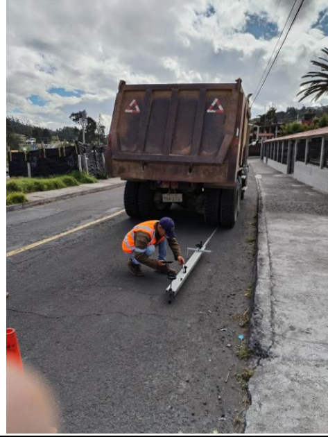
Fotografía 1. Toma de deflexiones en la capa de rodadura
