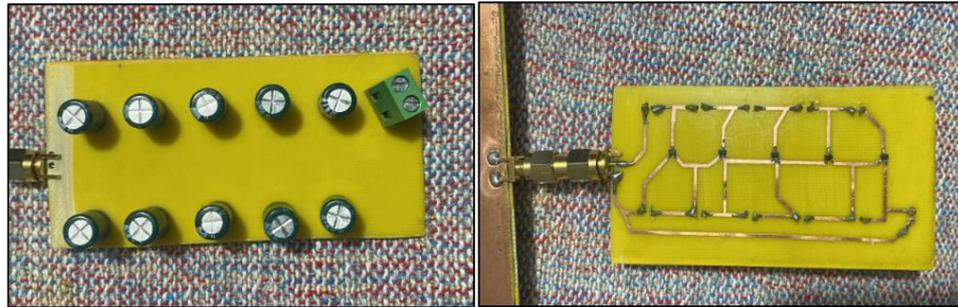
**Figura 32.** Rectificador multiplicador de Voltaje implementado.
