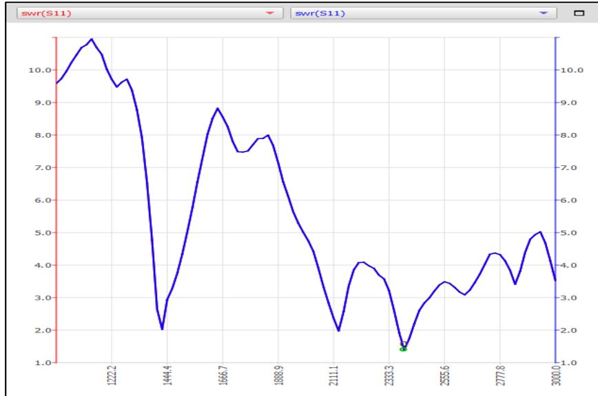
**Figura 36.** Parámetro SWR de la antena medido con el NanoVNA.
