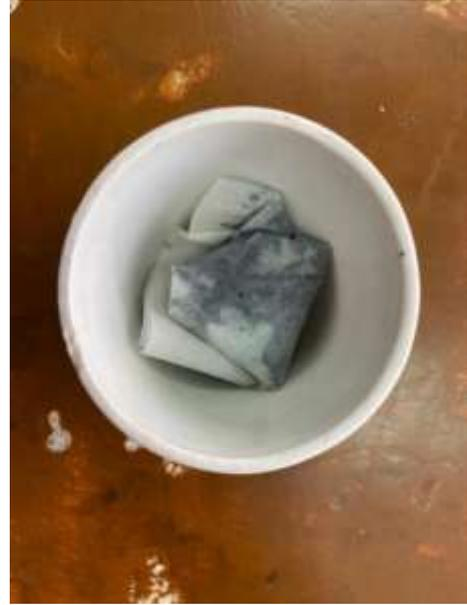
**Figura 20.** Determinación de cenizas insolubles en ácido clorhídrico.
