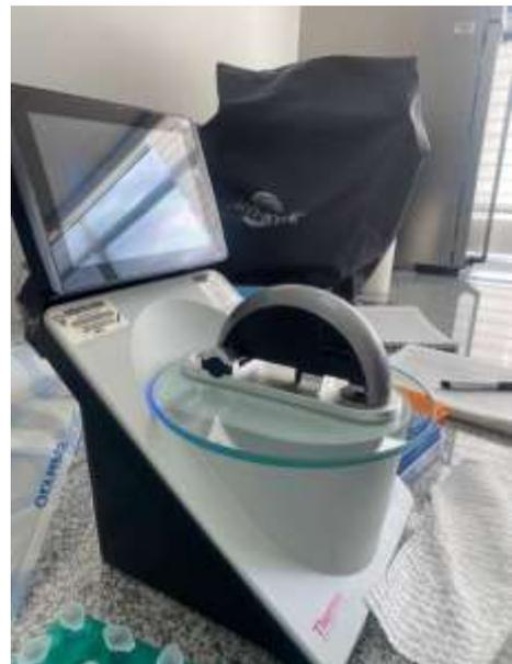
**Figura 22.** Espectrofotómetro NanoDrop ONE.
