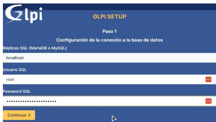
Gráfico 30. Configuración de la conexión de la base de datos Elaborado por: Danilo Tenelema
