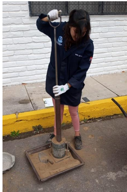
Figura 5 Ensayo Proctor modificado.
