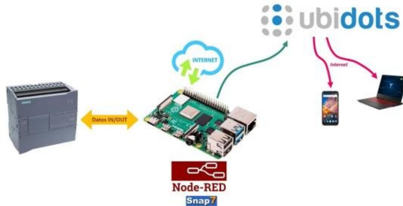
Figura 98. Arquitectura de comunicación IoT
