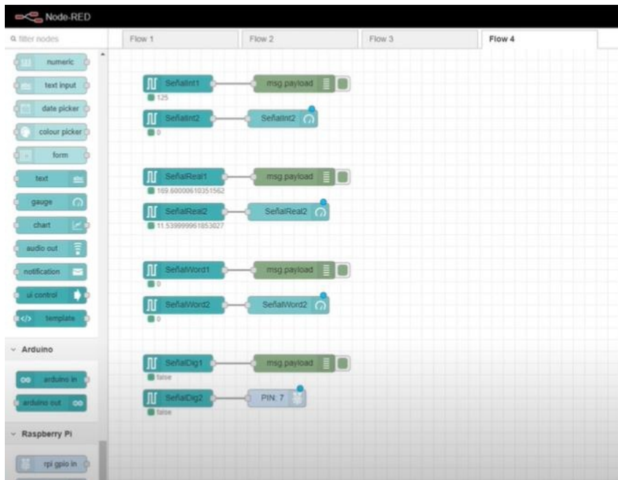
Figura 103. Conexión de las variables de PLC a Node-RED
