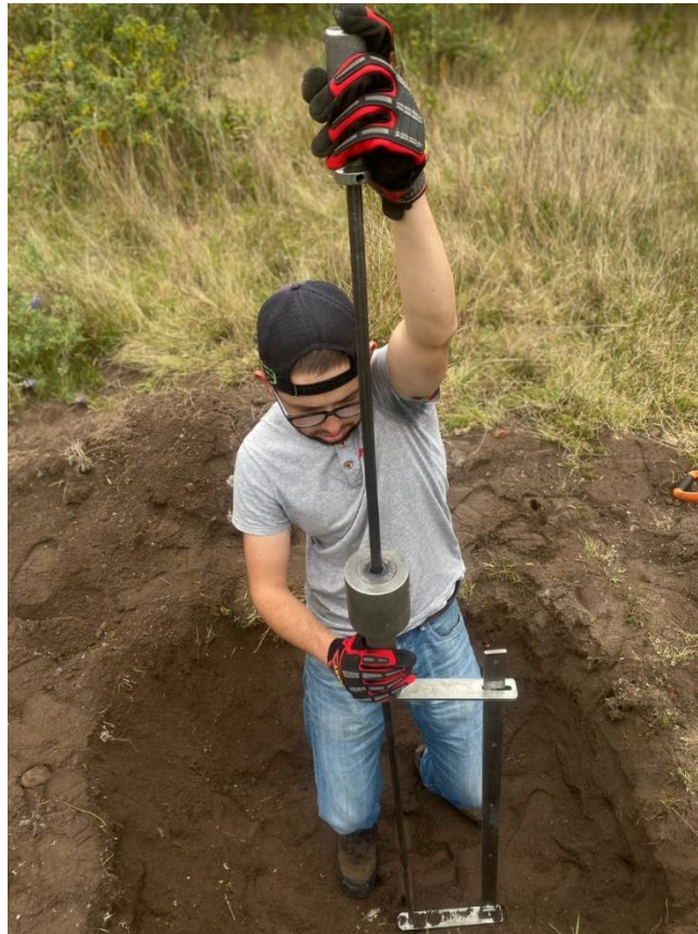
Figura 43 Ejecución del ensayo con el cono dinámico de penetración
