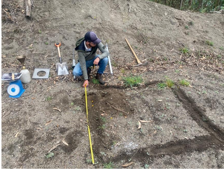
Figura 42 Dimensionando el tamaño de la calicata a excavar
