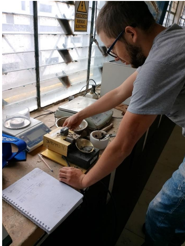
Figura 46 Determinación de límite líquido de la muestra en la copa de Casagrande
