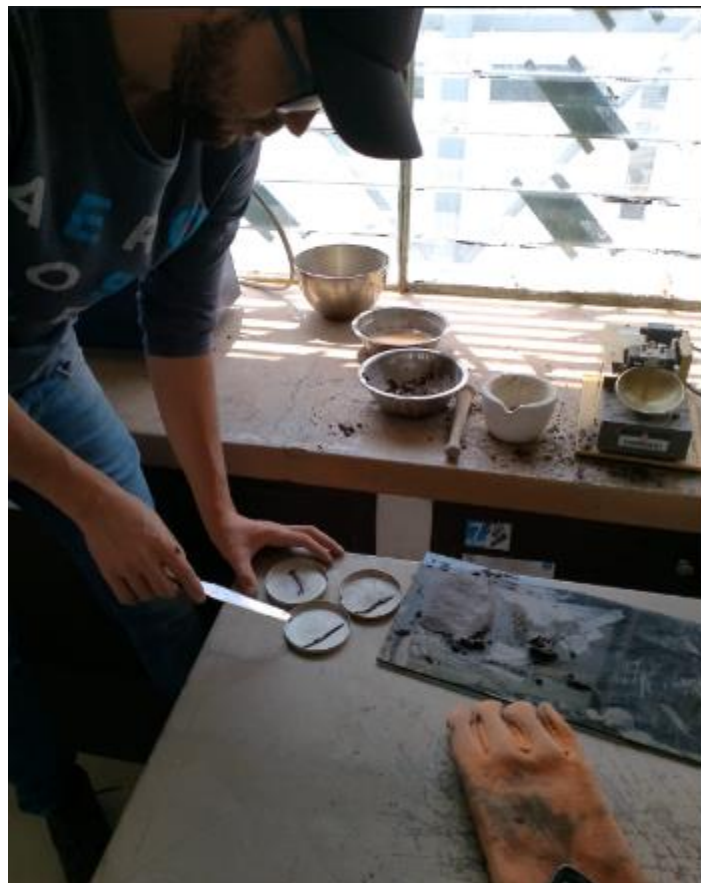
Figura 47 Elaboración de rollos para obtener el límite plástico de la muestra
