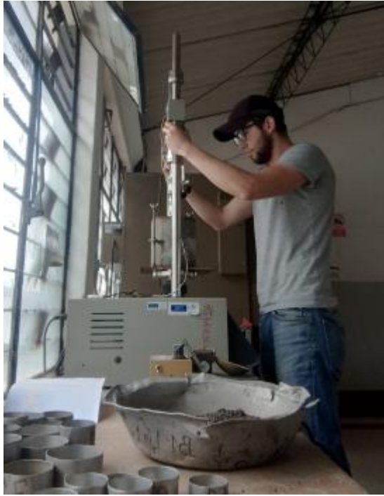
Figura 50 Colocación del molde con el suelo en la máquina Multispeed 34-V1172
