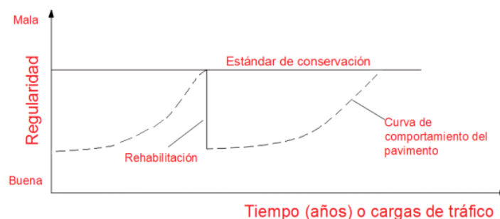
Figura 2. Deterioro de un pavimento a través del tiempo
