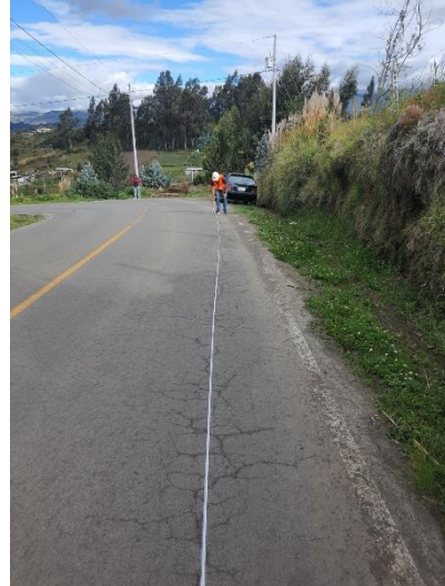
Fotografía 2. Conteo y tipificación de fallas presentes en el pavimento
