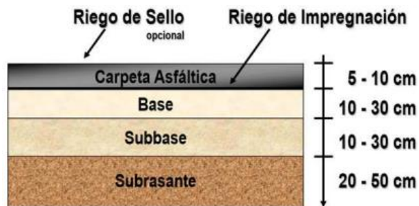
Figura 1. Estructura del pavimento flexible
