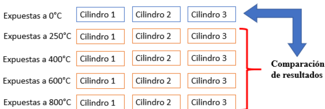
Figura 9. Metodología utilizada para la quema de cilindros por cada % de AR Fuente: Byron Javier Quishpe Toapanta
