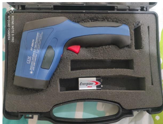
Figura 8. Pirómetro utilizado para el control de temperatura Fuente: Byron Javier Quishpe Toapanta
