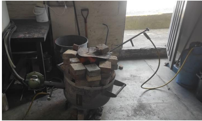
Figura 7. Soplete en el interior del horno para la quema de probetas Fuente: Byron Javier Quishpe Toapanta
