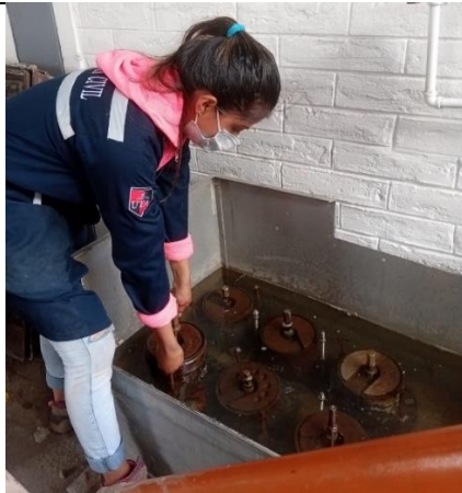
CBR- Saturación de moldes
