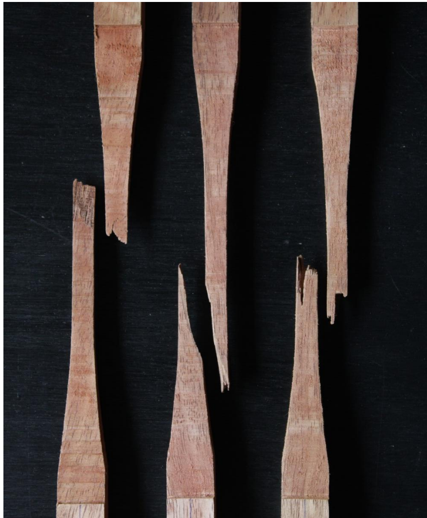
Izquierda: Falla tipo (c) tensión cortante
