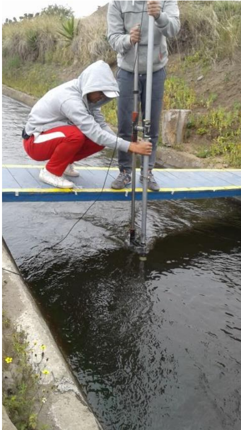
Colocación de marcas en las medidas a los 0.2, 0.6 y 0.8 de la profundidad del agua
