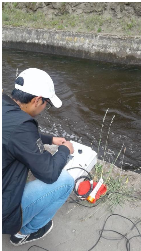
Molinete; equipo para la medición de caudales
